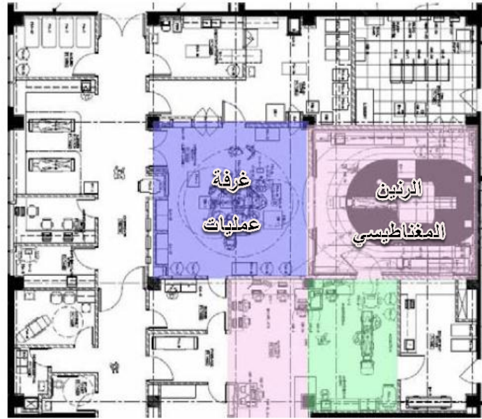
شكل رقم (٢٩-٣): مخطط يوضح غرفة العمليات الهجينة و علاقتها مع غرف الرنين المغناطيسي شكل رقم (٣٠-٣): صورة توضح باب غرفة الرنين المغناطيسي من داخل غرفة العمليات
